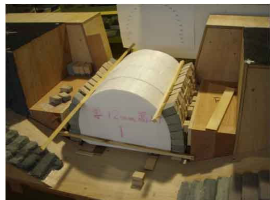
写真 4 アーチ石の組み立て状況
