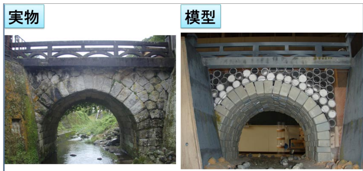
写真 8 実物と模型の比較（下流側） 側壁は内部が観察できるように透明アクリル板を使用した
