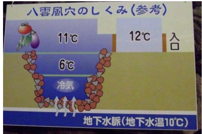
写真 7 八雲風穴のしくみ(説明看板より)
