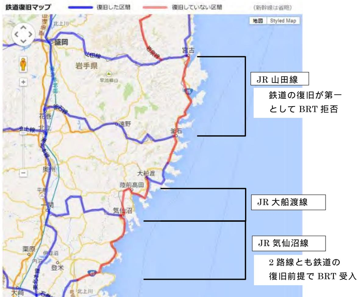
図 2 津波により甚大な被害を受けた沿岸の鉄道路線
