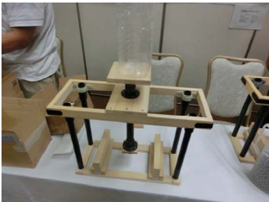
P21 橋破壊実験装置
