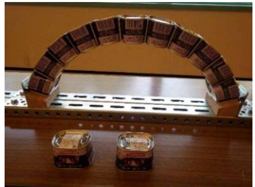
写真-2 コンビーフ・アーチ橋
