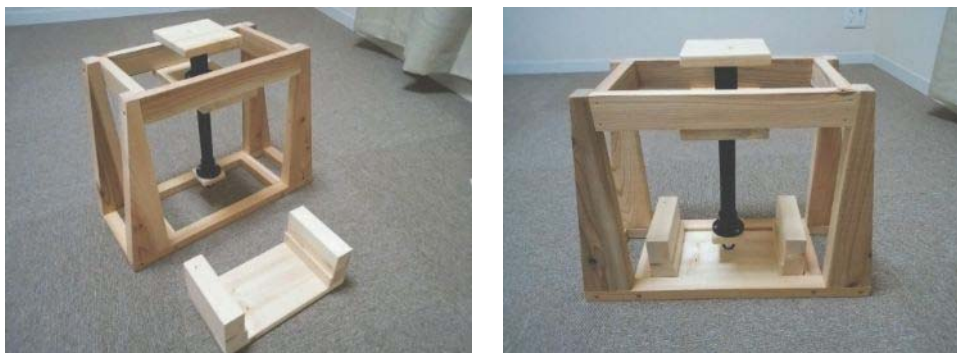
載荷装置 島根県技術士会バージョン(左：橋台設置前、右：橋台設置後)
