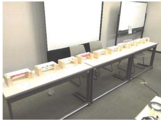
完成した10個の橋。ほぼみんなが 1.5kgの荷重に耐えられる橋を作りま
