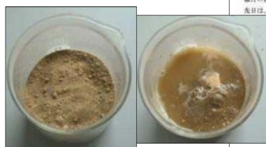
上写真：液状化実験の例。 左写真の状態水を入れ、振動を与えると埋設物が水と共に浮き上がってくる。
