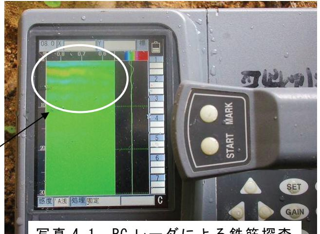
写真 4.1 RC レーダによる鉄筋探査
