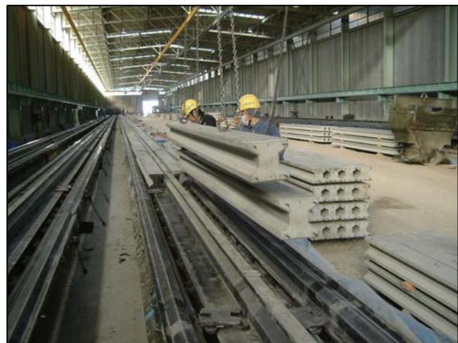
図 3-6. 等断面のH形コンクリート杭及び製造状況（同様）
