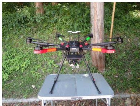
図 4-2 使用した UAV レーザ機器
