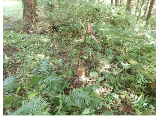
写真-10 隣の谷で見つかった用地境界杭
