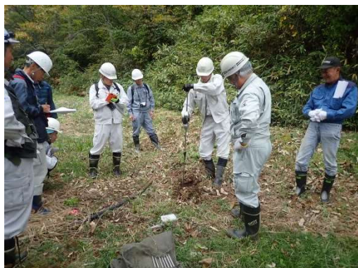
写真-7 簡易貫入試験によるトンネル 位置の探査
