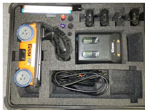
図 4-6. ストラクチャスキャン SIR-WZ XT
