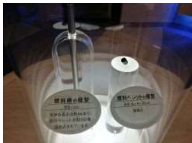
燃料ペレット（ \phi 1\text{ cm} \times 1\text{ cm} ）
