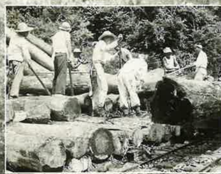
④機械集材線で集積場に集めた後、トロッコに積み込む。
