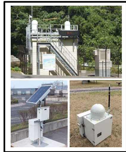
モニタリングポスト 上：固定局、右下：可搬型、左下：簡易型
