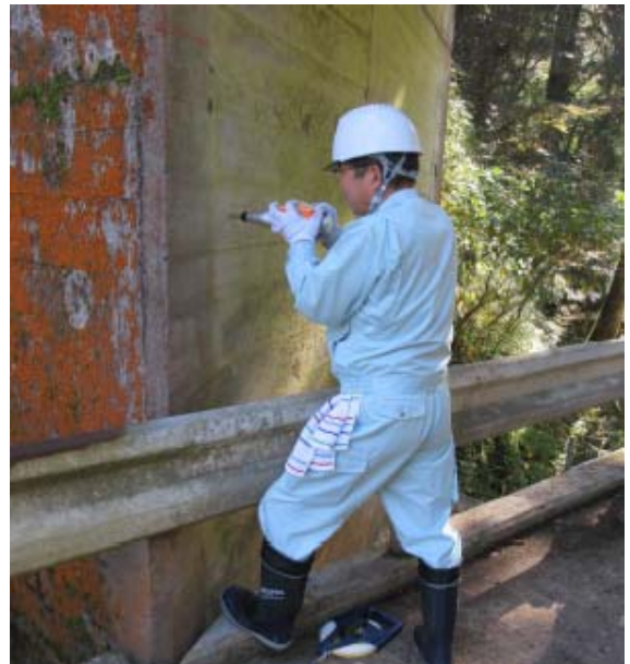
写真-4 反発硬度試験状況
