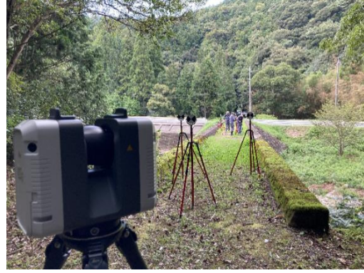
写真6 GNSS、ターゲット設置状況
