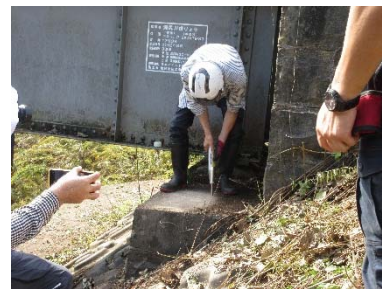
図 20. シュミットハンマーによる計測
